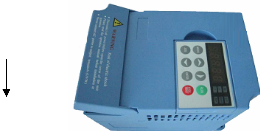
图 2-4 安装端子外罩
